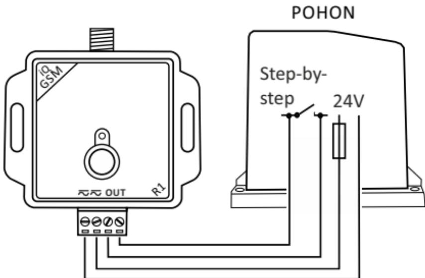
Příklad napájení 12V (zdroj, baterie) a zapojení výstupu přes relé (oddělení pro ovládání silového okruhu).
